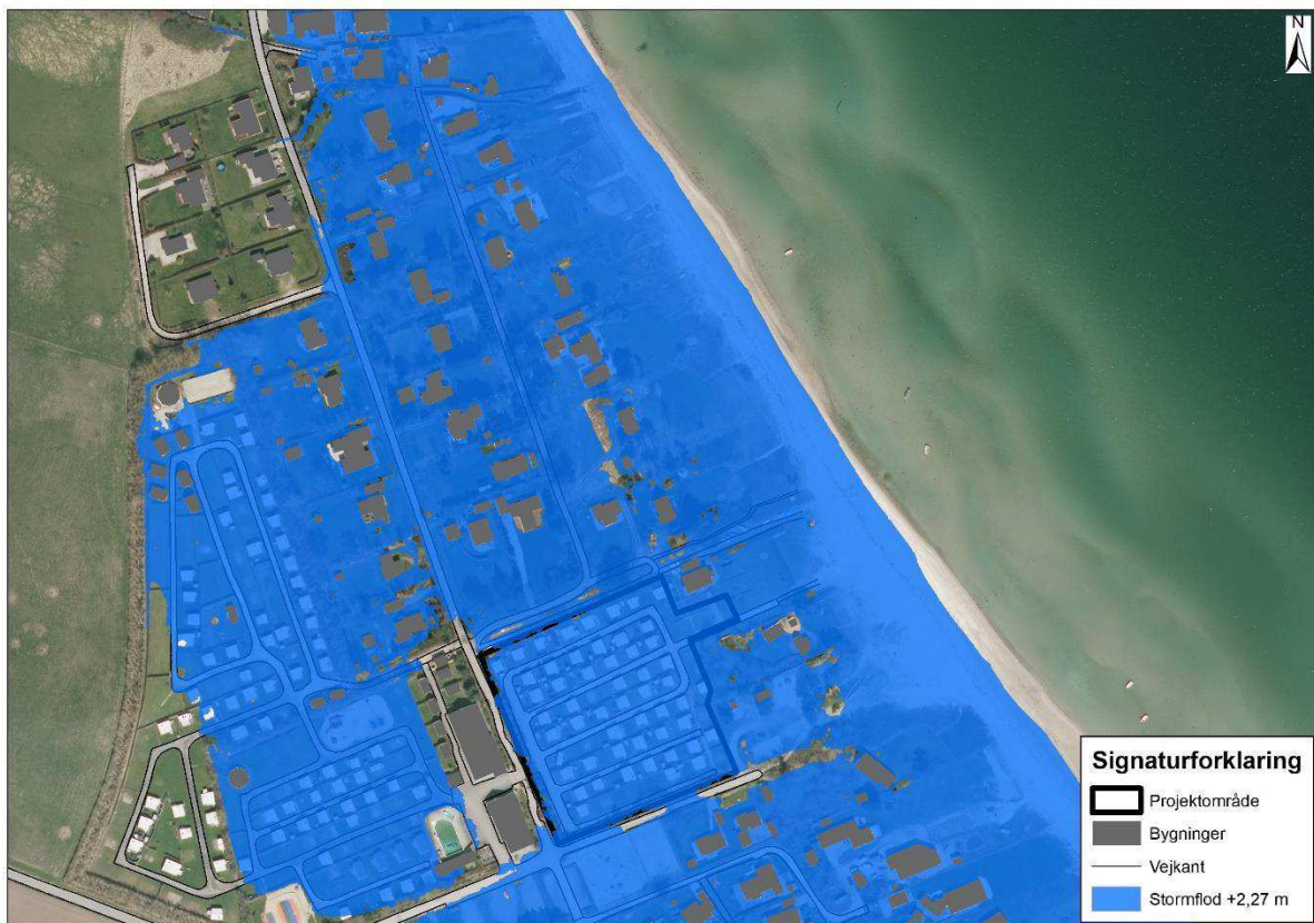
Figur 6 Oversvømmede arealer ved projektområdet som et resultat af en fremtidig 100-årshændelse for stormflod (vandstandskote +2,27 m).
